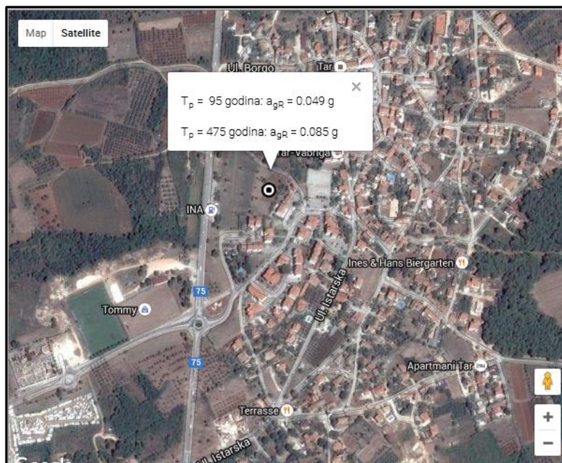
Slika 5. Horizontalna vršna ubrzanja tla tipa A ( a_{gR} ) za povratna razdoblja od T_p = 95 i 475 godinaza lokaciju pogona za proizvodnju proizvoda ribarstva
